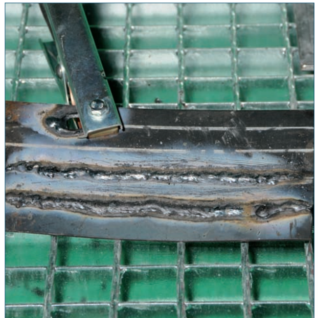
11.5. Cordón de soldadura.
